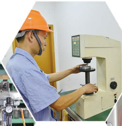
检测零部件硬度 Detects component hardness
